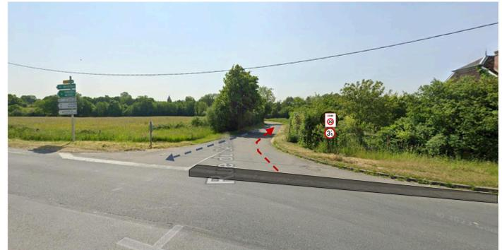
Retrait du panneau sens interdit et ajout d'un panneau interdiction aux plus de 3T5 (B13) et zone 30km/h (B30), marquage noir sur la bande de stop. Remise en double sens de la rue du capitaine Lemaire jusqu'au carrefour avec la rue du Moulin.
