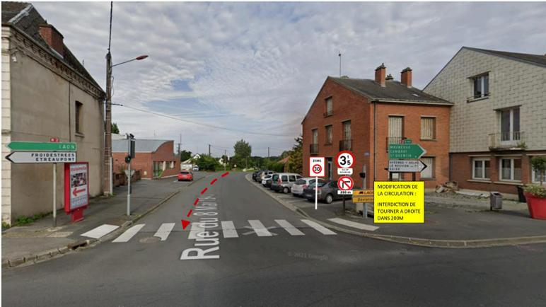
Rue du 8 mai 1945 à double sens. Retrait du panneau sans issues. Ajout d'un panneau d'interdiction aux plus de 3T5 (B13) sauf services (M92) ainsi qu'un second panneau d'interdiction de tourner à droite (B2b) dans 200m (M1) sur le mât existant. Ajout d'un panneau d'entrée dans une zone 30 (B30) sur mât provisoire. Panneau provisoire jaune pour rappeler temporairement la modification de circulation.
