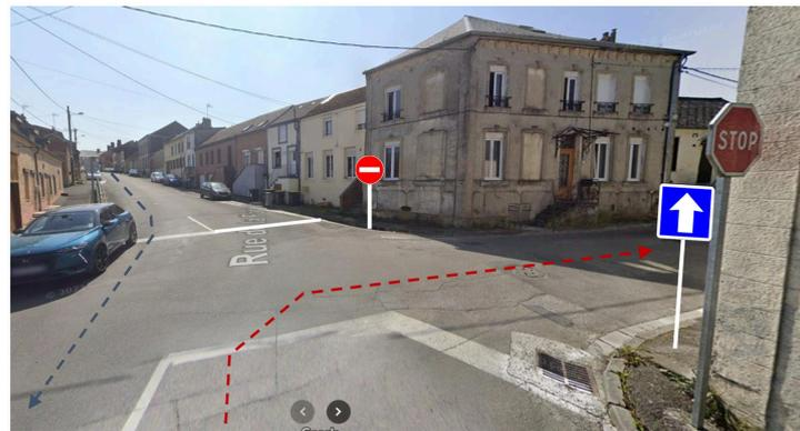
Mise en sens unique de la rue du Capitaine Lemaire et de la rue du Moulin. Prolongement de la bande stop sur toute la largeur de la voirie, ajout d'un panneau sens interdit (B1) et d'un panneau sens unique (C12) sur des socles provisoires.
